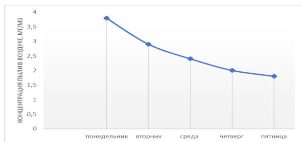
Рисунок 7. Изменение среднесуточной концентрации пыли в воздухе цеха швейного предприятия в результате работы беспилотного робота-уборщика Figure 7. Change in the average daily dust concentration in the workshop air of a sewing enterprise as a result of the operation of an unmanned cleaning robot
