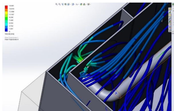
Рисунок 9. Распределение потоков перед попаданием в воздуховод внутри камеры
