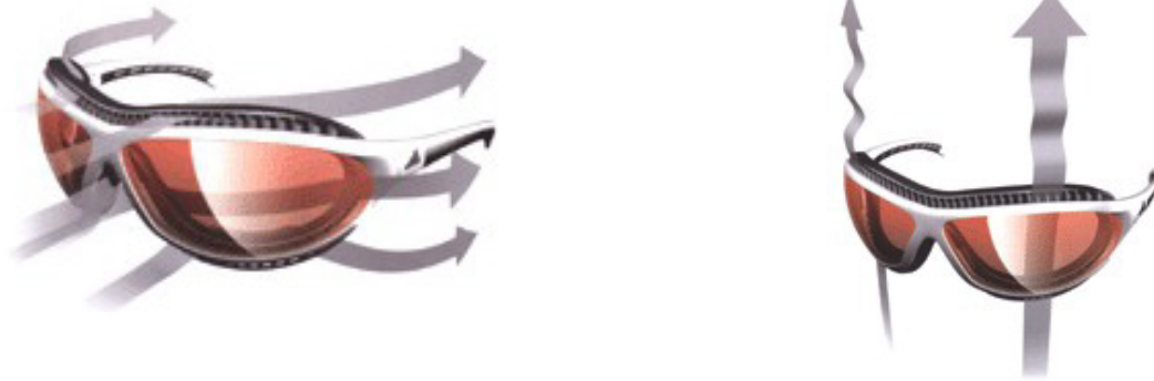
Рис. 2. Схема воздушных потоков с технологией Clima cool [18]
