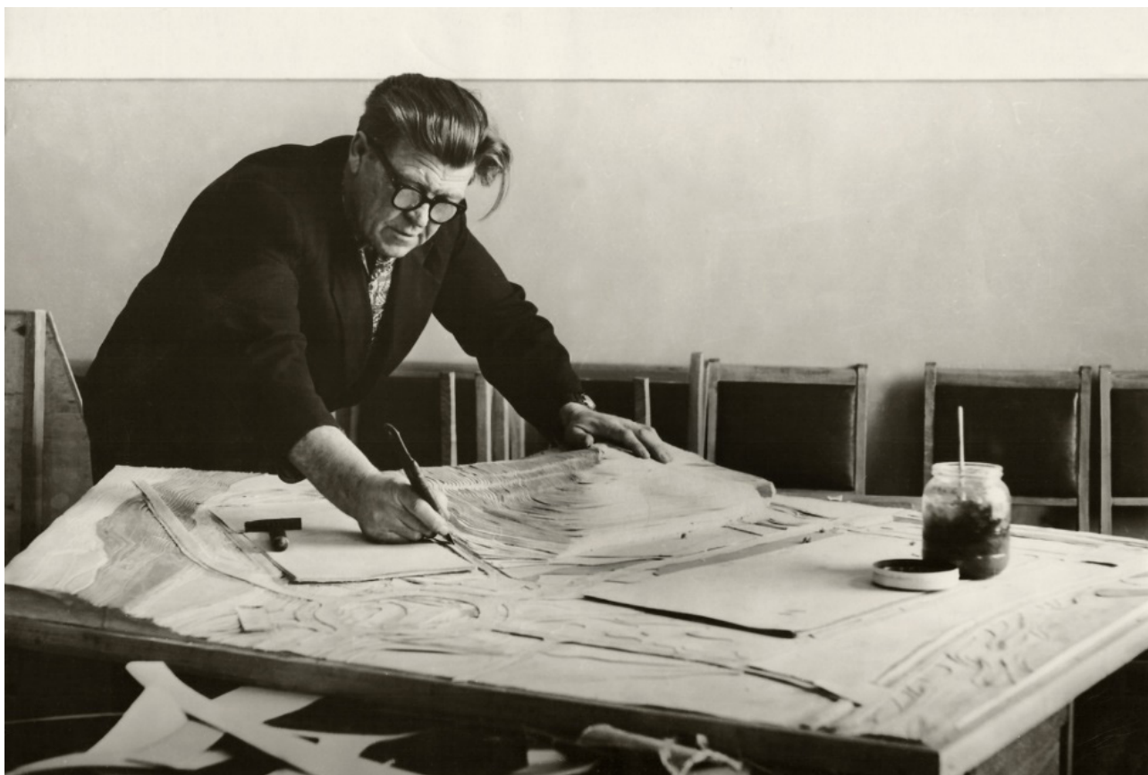
Рис. 3. Макетчик И.А. Барис выполняет рельеф из слоев картона. Макетная мастерская при НГПИ (фотография из архива Бариса А.В.)
