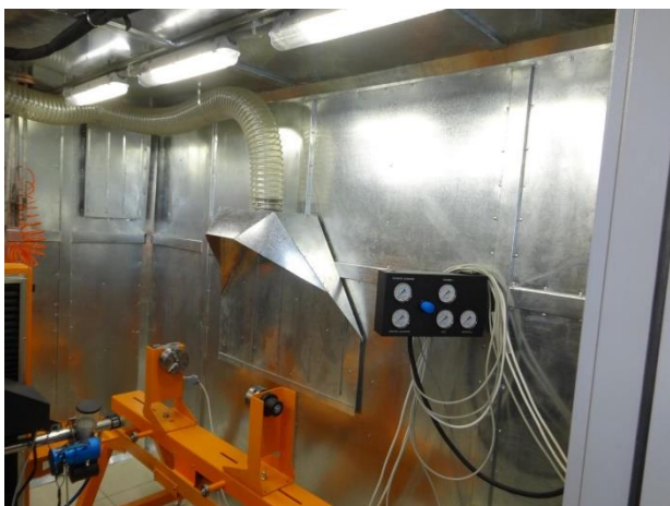
Рисунок 4. Установка для напыления с зонтом локальной вентиляции
